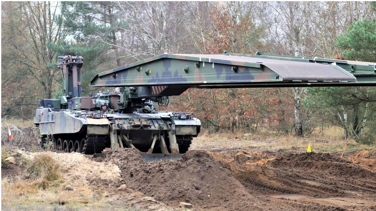
Der Brückenlegepanzer Leguan kann Geländeeinschnitte und Schluchten von bis zu 24 Meter Breite überwinden. Bis zu 72,6 Tonnen schwere Panzer können die Brücke passieren und sogar bis zu 83,5 Tonnen schwere Radfahrzeuge.
