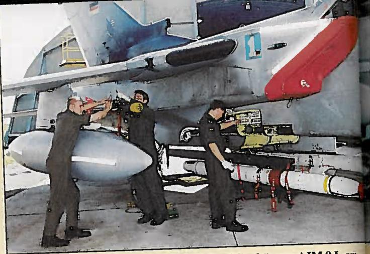
Anbringen eines Sidewinder Luft-Luft-Lenkflugkörpers AIM 9 L am Launcher durch Mechaniker. Die Verantwortung der Techniker ist groß. Ein Techniker baut an, der andere prüft und unterschreibt
