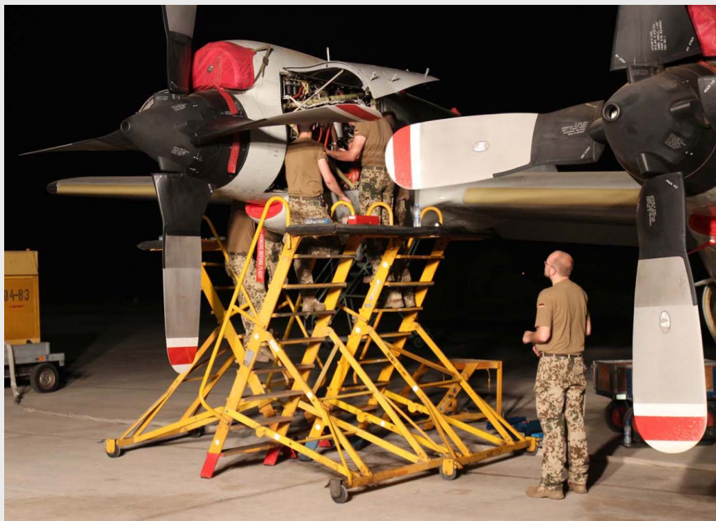
ATALANTA-Einsatz: Behebung einer Störung am Triebwerk Seefernaufklärer P-3C ORION
