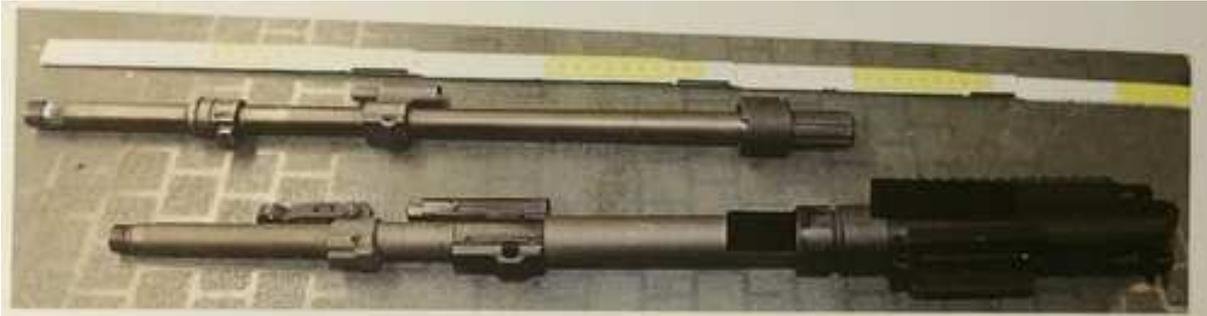
**Abbildung 90:** Vergleich des Waffenrohres zwischen dem Fabrikat A und dem G36 A1. Das Waffenrohr des Fabrikats A ist deutlich dicker, womit es erstens die schussinduzierte Temperatur besser aufnehmen kann und zweitens ein ganz anderes Schwingungsverhalten aufweist, was eine deutlich höhere Präzision ermöglicht.
