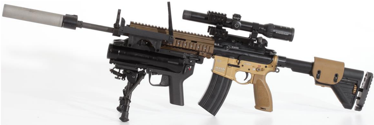
Abb. 1: Sonderwaffe/Leichtes Maschinengewehr „HK416Bw“, Kaliber 5.56mm NATO, ausgestattet mit einem variablen Zielfernrohr (Vergrößerung 1.5-6x), Schalldämpfer und einem Granatwerfer im Kaliber 40mm LV.
